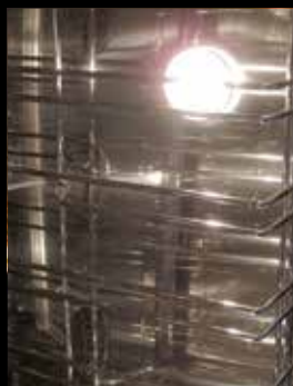
OŚWIETLENIE KOMORY PIECA
